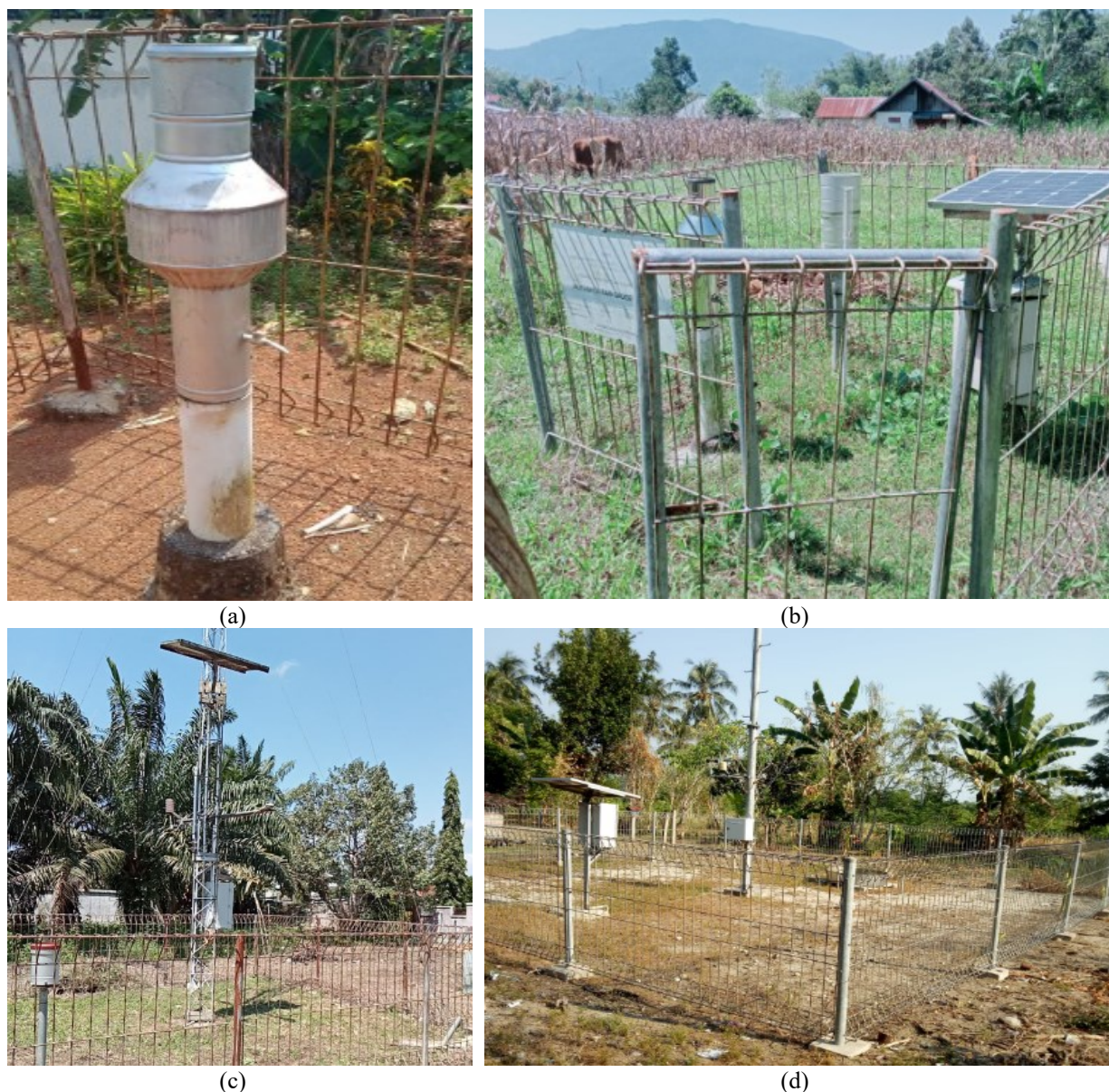
Gambar 2. Peralatan konvensional dan otomatis. (a) Penakar Hujan Observatorium atau Pos Hujan (PH), (b) Automatic Rain Gauge (ARG), (c) Automatic Weather Station (AWS) dan (d) Automatic Agroclimate Weather Station (AAWS)
